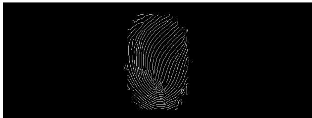
图 2 Gabor 滤波后的指纹图像细化结果
